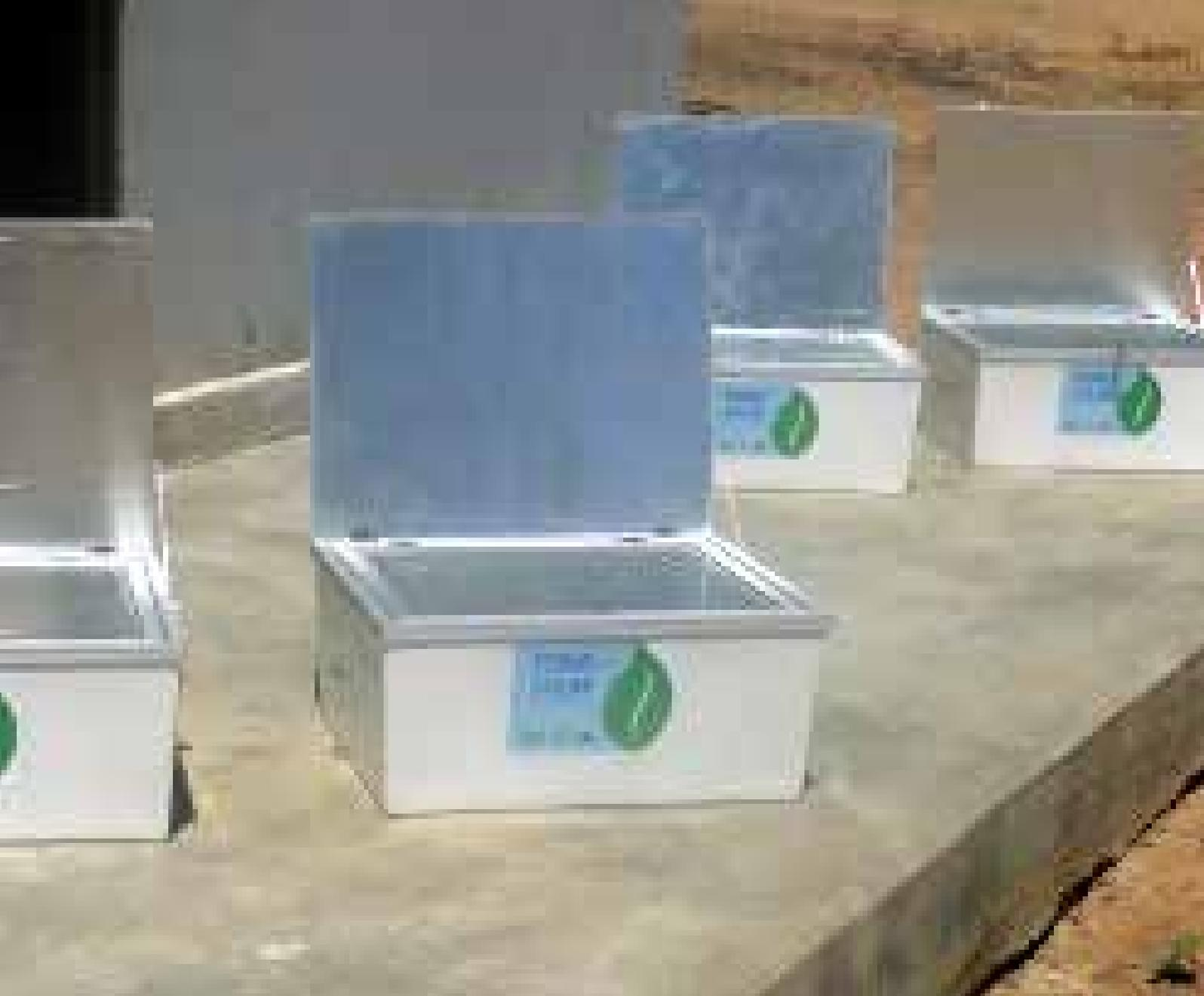
O Forno Solar é uma tecnologia que tem grande potencial de uso nas regiões semiáridas que possuem boa incidência de energia solar. Essa tecnologia não necessita de nenhum tipo de combustível ou lenha, contribuindo para a redução do desmatamento e emissão de gases de efeito estufa.
