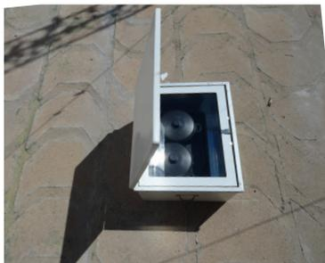
Isso significa que duas das paredes prateadas da caixa interna estão na sombra, reduzindo a captação da luz solar e, por isso, reduzindo também o calor interno do forno.
