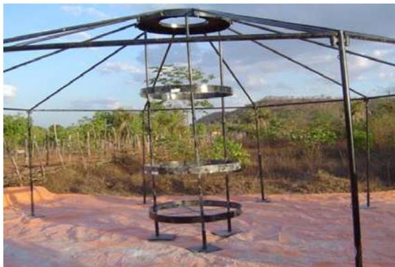
Imagem 44: Esqueleto metálico do secador solar – Foto: SDA
